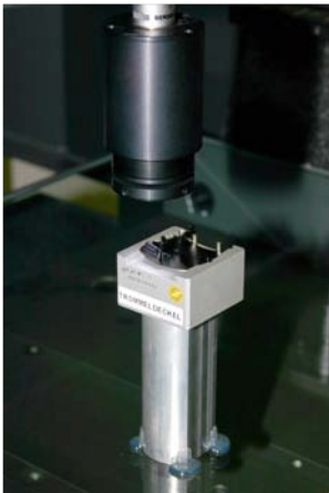
Mit der schwenkbaren Sensor-Optik können Bauteile in einer Aufspannung von oben (links) und der Seite (rechts) gemessen werden
