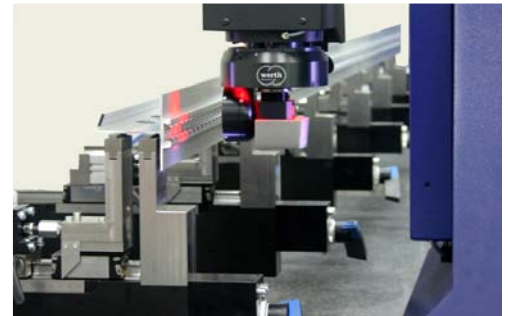
Das Spannen der Profile dauert nur wenige Minuten
