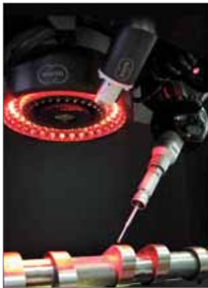
L'épiscopie annulaire: Elle est rapportée sur l'objet à mesure sous un angle incliné par rapport à l'axe optique (MultiRing Werth avec angle modifiable). Les machines de mesure de coordonnées modernes permettent d'utiliser séparément les trois sources de lumière.
