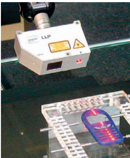
Bild 2. Mit dem Laser-Liniensensor lassen sich Freiformflächen schnell und berührungslos erfassen.
