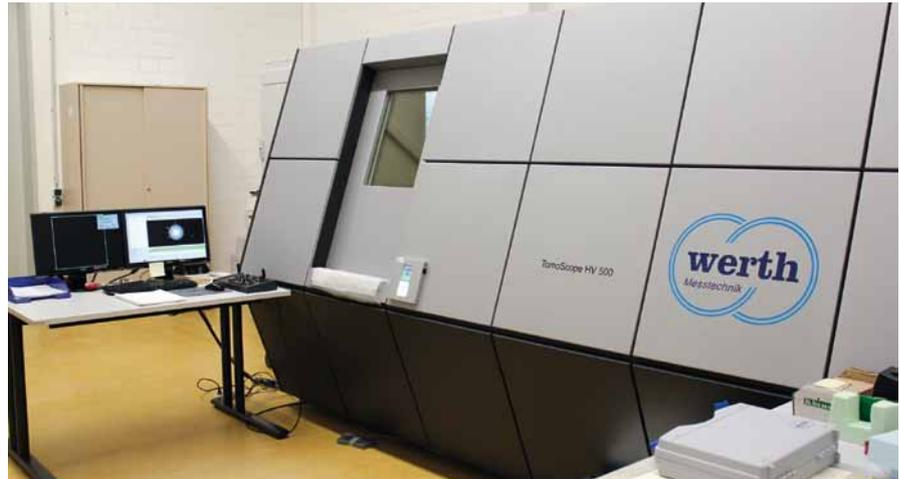
▲ Der Computertomograph wird für geometrische Messaufgaben und Materialanalysen eingesetzt.
