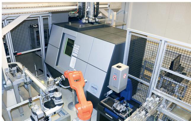
Bild 2. Die automatisierte, in den Fertigungsprozess integrierte Messzelle enthält zwei Koordinatenmessgeräte – eines mit Röntgentomografie (links im Bild) sowie eines mit leistungsstarker Bildverarbeitung (rechts). (© Werth Messtechnik)
