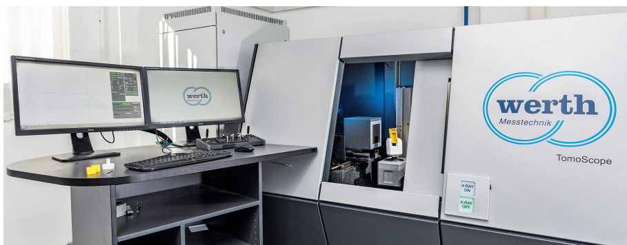
Messtronik nutzt mehrere Multisensor- und Computertomografie-Koordinatenmessgeräte von Werth, dazu gehört das CT-Gerät Tomoscope S Bild: Messtronik
