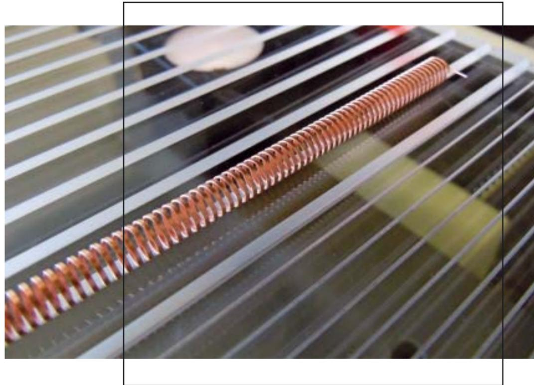
Die Drahtwendeln für die verschiedensten Bauformen der Wanderfeldröhren für die Signalverstärkung von Satelliten werden bei Thales Electronic Systems in einem komplizierten Prozess mit extrem hohen Anforderungen an die Präzision hergestellt. Bilder: Werth
