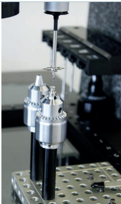
**Bild 2.** Die Locking Inserts benötigen sowohl taktile als auch optische Messungen – ein ausschlaggebendes Argument für ein Multisensor-Messgerät.
