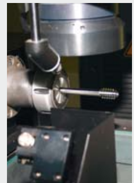
Die zusätzliche vierte Achse vereinfacht das Messen rotationssymmetrischer Teile.
