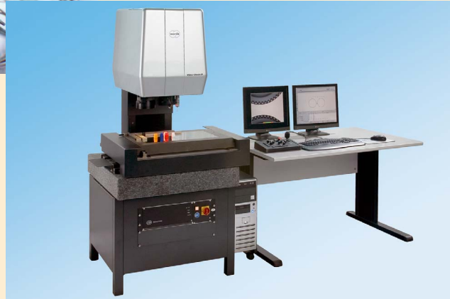
Admedes vertraut in der Qualitätssicherung auf den langjährigen Partner Werth Messtechnik. Dessen Video- und ScopeCheck-Messgeräte werden unter anderem in der „Feindimensionsmessung“ eingesetzt.
