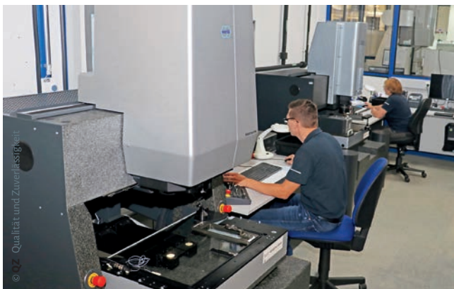
Bild 1. Die 3D-Koordinatenmessgeräte sind mit hochgenauen optischen und taktil-optischen Sensoren ausgestattet. (© Werth Messtechnik)
