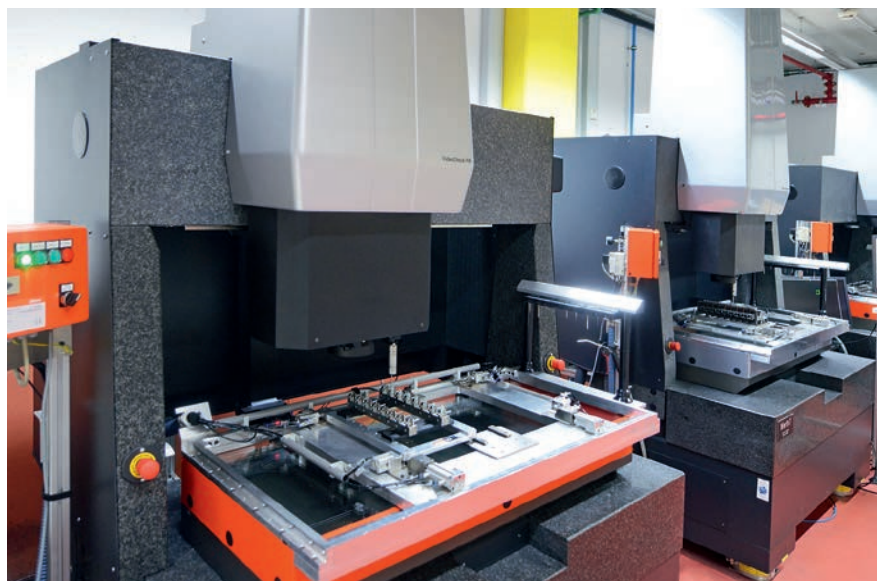
Bild 2. Für hochgenaue Messaufgaben: VideoCheck-Geräte erreichen in ihrer höchsten Genauigkeitsklasse Längenmessabweichungen im Zehntel-Mikrometerbereich (© Blum)
