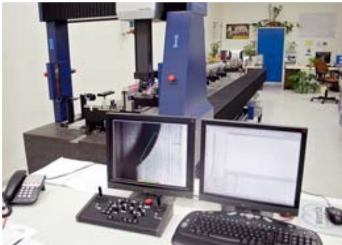
**Die 3D-Messsoftware unterstützt die Offline-Programmierung und ebenso das interaktive Messen**
