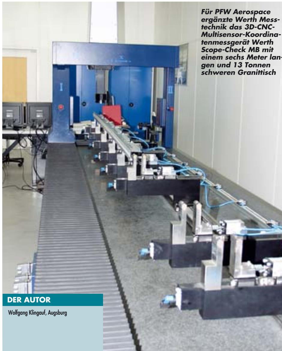
**Für PFW Aerospace ergänzte Werth Messtechnik das 3D-CNC-Multisensor-Koordinatenmessgerät Werth Scope-Check MB mit einem sechs Meter langen und 13 Tonnen schweren Granittisch**
