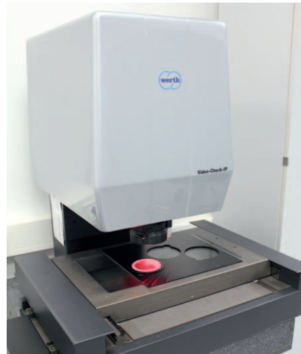
Bild 3. Beim Scannen: Mit dem Bildverarbeitungssensor werden Wafer auf Verunreinigungen mit Partikeln inspiziert.
