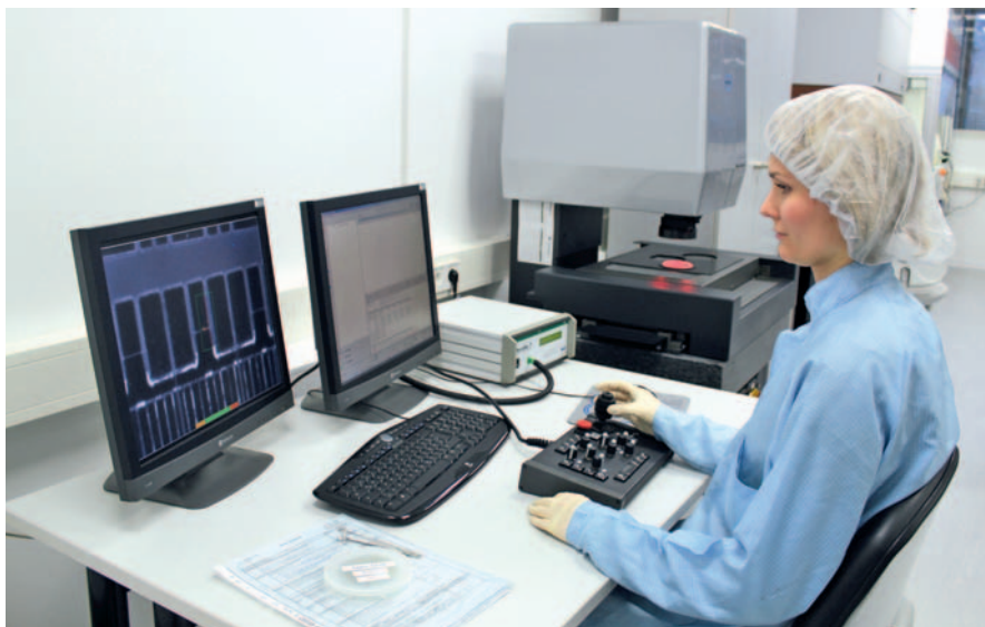
Bild 1. Im Reinraum: Die Mitarbeiter setzen ein 3D-CNC-Multisensor-Koordinatenmessgerät mit chromatischem Fokussensor zur Wafer-Dickenmessung ein.
