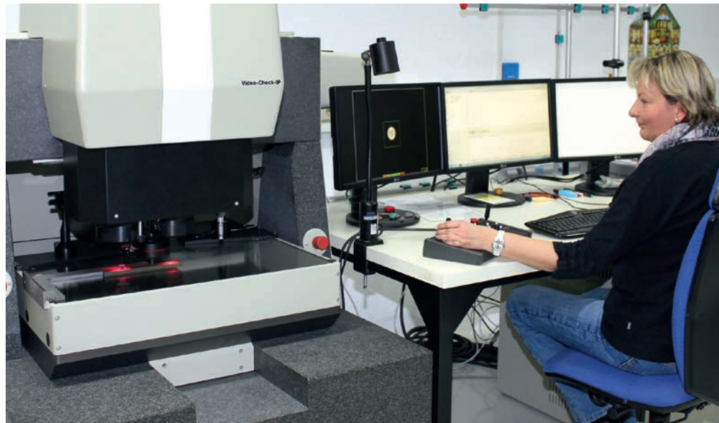
Bild 1. Das Portalmessgerät ist mit einem telezentrischen Objektiv sowie einem Fasertaster und einem konventionellen Taster ausgestattet.
