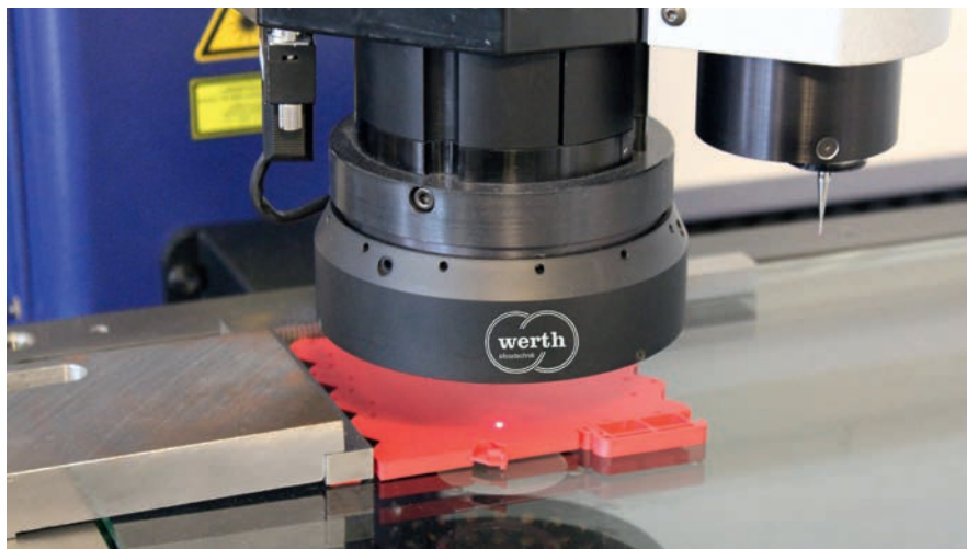
Bild 2. Messen der Ebenheit von Kunststoffplatten. Mit dem Laser des 3D-Multisensor-Koordinatenmessgeräts verringert sich die Prüfzeit um rund zwei Drittel.
