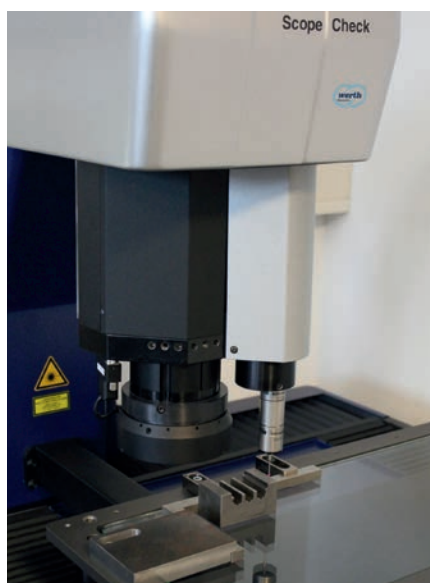
Bild 3. Beim taktilen Messen müssen die Bauteile richtig gespannt werden, um das Ausweichen durch die Berührung zu vermeiden. Die Vorrichtungen werden später in der Serienfertigung übernommen.
