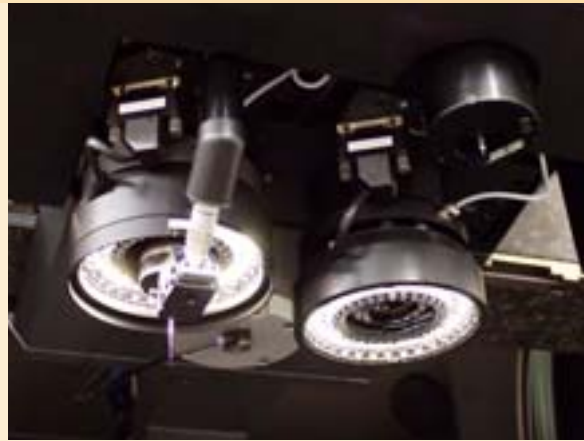
Ein Werth Bildverarbeitungssensor ermöglicht die vollautomatische Messung komplizierter, extrem kontrastarmer Werkstücke im Durch- und Auflicht
