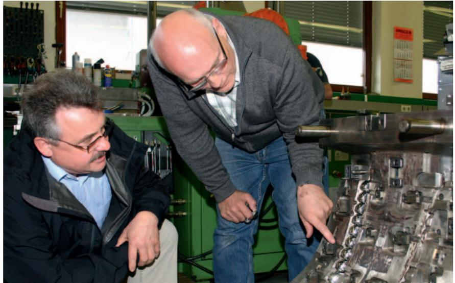
**Nachkorrektur:** Herbert Layher (links, Hema CT) und Werner Vesper (Vema) begutachten die Formwerkzeuge, die den Grundstein für hochpräzise Kunststoffteile legen. Nach dem Messen erster Spritzgussteile müssen eine oder mehrere Korrekturen des Werkzeugs erfolgen, um die Präzision der Teile zu optimieren.
