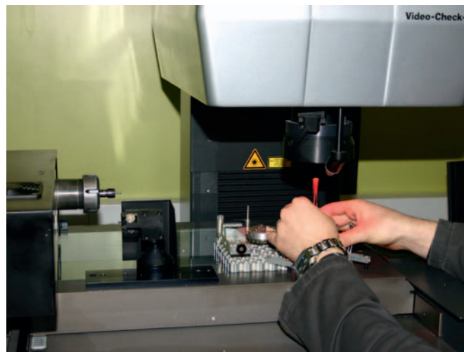
Bild 3. Der Messbereich wurde so gestaltet, dass die Spannange und die meisten Vorrichtungen auf dem Gerät verbleiben können und so ein schneller Bauteilwechsel möglich ist.
