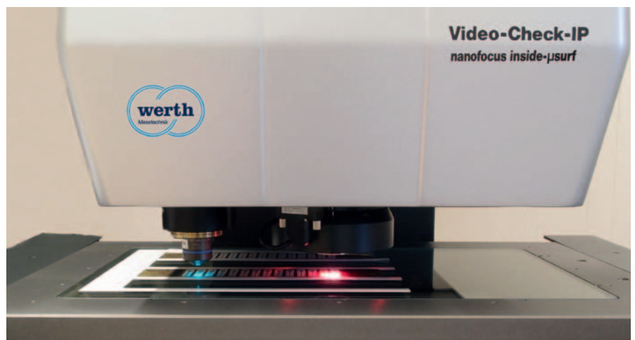
Bild 1. Optische Messköpfe, rechts der Bildverarbeitungssensor (rotes Auflicht) und links der Nanofocus-µsurf-Messkopf (blau) im sequenziellen Betrieb. (Fotos: Roche)
