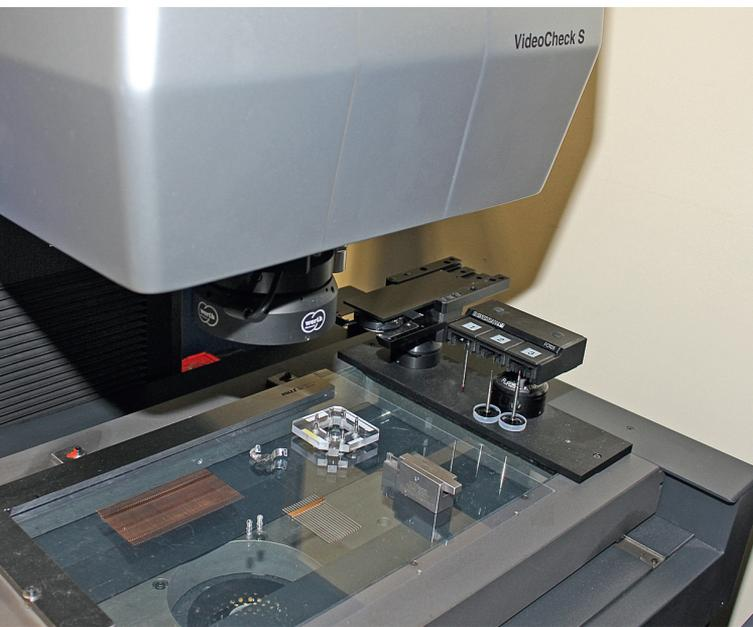
Das im Qualitätslabor installierte Videocheck S verfügt über einen in den Bildverarbeitungsstrahlengang integrierten Werth Laser Probe und ein messendes Tastsystem, das über das Multisensor-System ebenfalls versatzfrei eingewechselt werden kann
