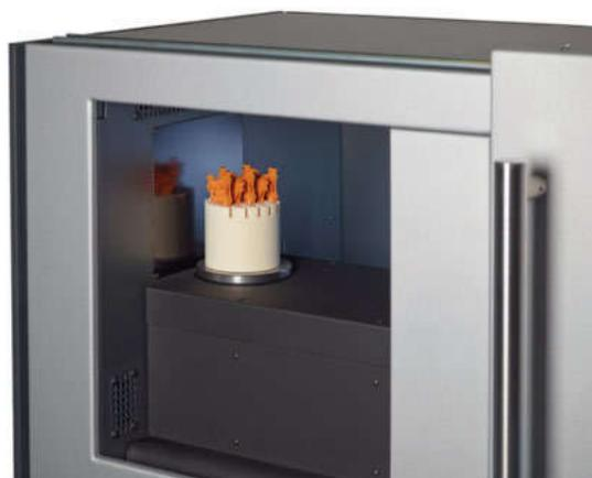
Mit dem Tomoscope XS FOV 500 ist die Messung von mehreren Werkstücken in einem Arbeitsgang möglich.
