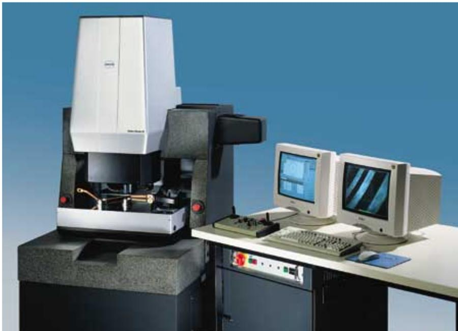
Multisensor-Koordinatenmessgerät Video-Check IP 400 der WERTH Messtechnik GmbH im direkten Datenverbund mit den Erodiersystemen AGIETRON oder AGIECUT heisst rückgekoppelte Präzision.
