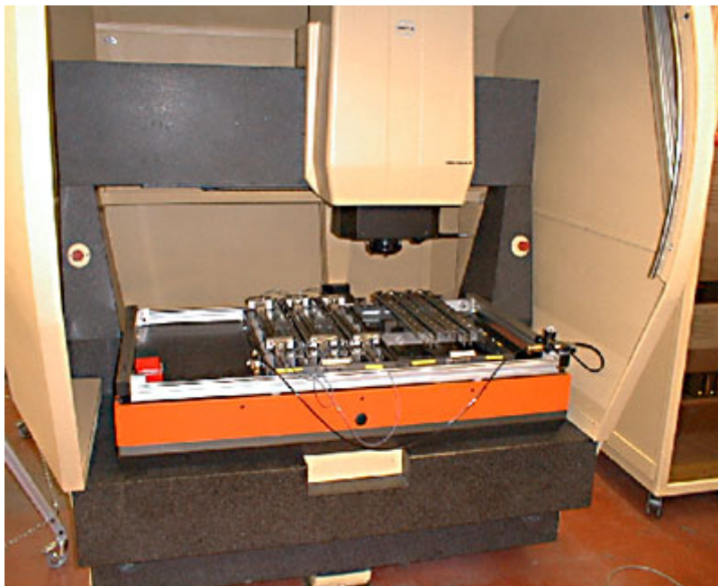
Abb. 16: Video-Check 650 mit bestückten Beschlägen und pneum. Klemmung
