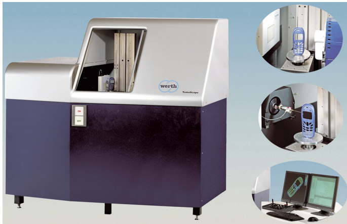
Abb.2: Werth TomoScope – Multi-sensor-Koordinatenmessgerät mit Computer-Tomografie
