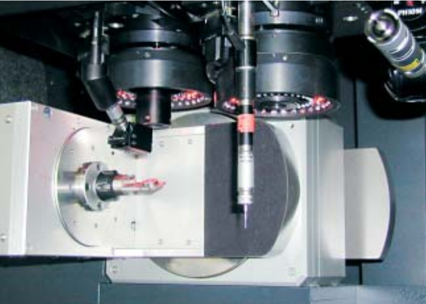
BILD 6. Messung an einer Düsenplatte mit Hilfe einer Dreh-/Schwenkachse. Das Multisensor-Koordinatenmessgerät verfügt neben dem Fasertaster, der vor einer Festoptik angebracht ist, über einen zweiten Strahlengang mit Zoomoptik, je ein schaltendes und ein messendes Tastsystem an einem Dreh-/Schwenkgelenk sowie eine Tasterwechselstation (nicht im Bild)
