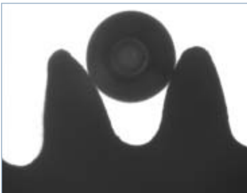
BILD 3. Schattendasein: Der Fasertaster im Durchlichtmodus bei der Messung eines Zahnrads
