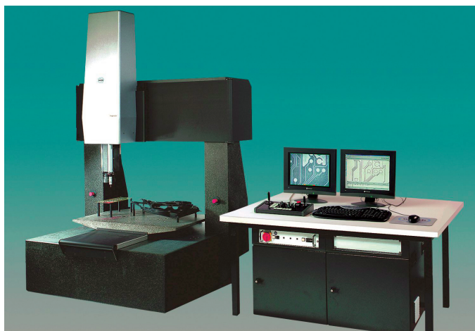
Der Werth Inspector ist das weltweit schnellste Koordinatenmessgerät in Multisensorbauweise
