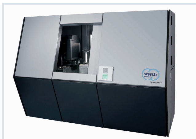
Bild 2. Computertomografie: CT-Koordinatenmessgeräte rekonstruieren das komplette Werkstückvolumen inklusive Innengeometrien aus Durchstrahlungsbildern des Werkstücks
