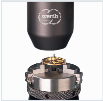
Bild 1. Chromatic Focus Line: Der Sensor erfasst etwa eine Million Messpunkte innerhalb von drei Sekunden © Werth
