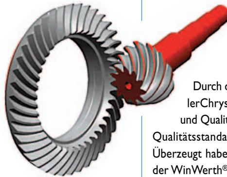
Das "Herz" des Hinterachsgetriebes besteht bei allen Modellen aus Tellerrad (links) und Antriebskegelrad (rechts).
