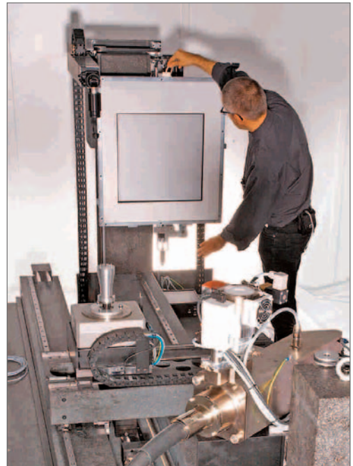
Ein Blick auf die noch nicht hinter dicken Bleiplatten "versteckte" Sensorik des neuen Werth TomoScope® HV 500
