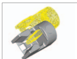
Automatische Grobeinpassung der Punktwolke auf das CAD-Modell
