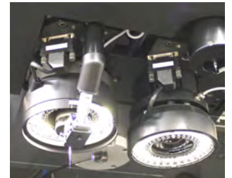
Ein Werth Bildverarbeitungssensor ermöglicht die vollautomatische Messung komplizierter, extrem kontrastarmer Werkstücke im Durch- und Aufsicht. Bild: Werth Messtechnik
