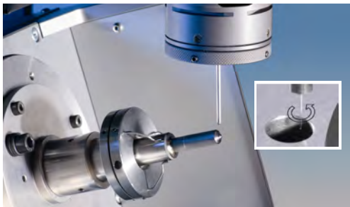
Rauheitsmessung an Commonrail Injektor
