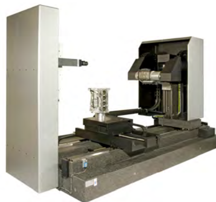
Werth TomoScope® HV 800 mit 450 kV Röntgenröhre
