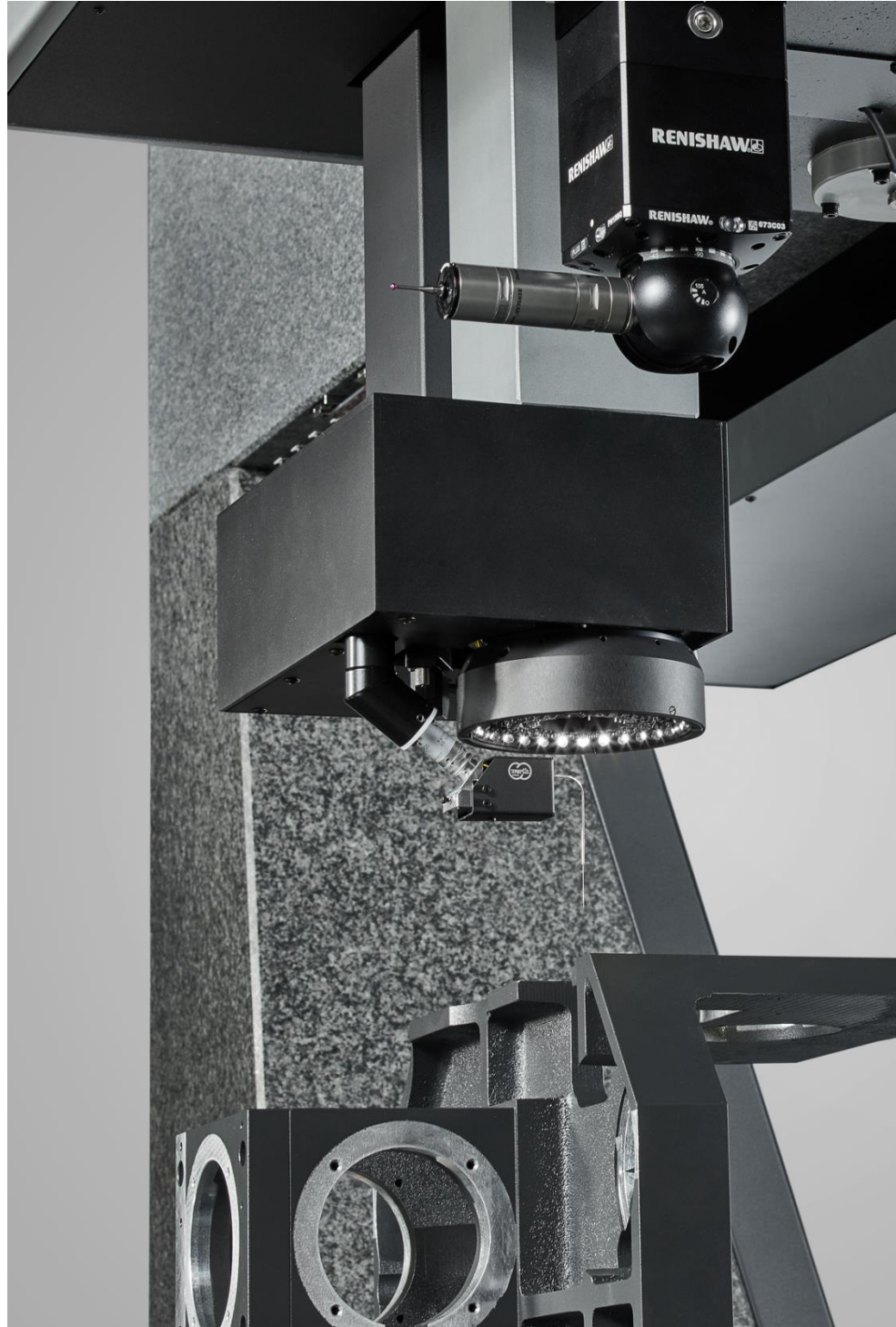
2-Pinolen-Konzept mit taktiler, optischer und taktil-optischer Multisensorik
