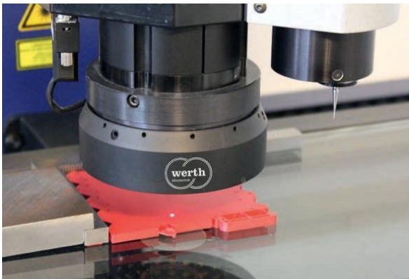
Messen der Ebenheit von Kunststoffplatten. Mit dem Laser des 3D-Multisensor-Koordinatenmessgeräts verringert sich die Prüfzeit um rund zwei Drittel.
