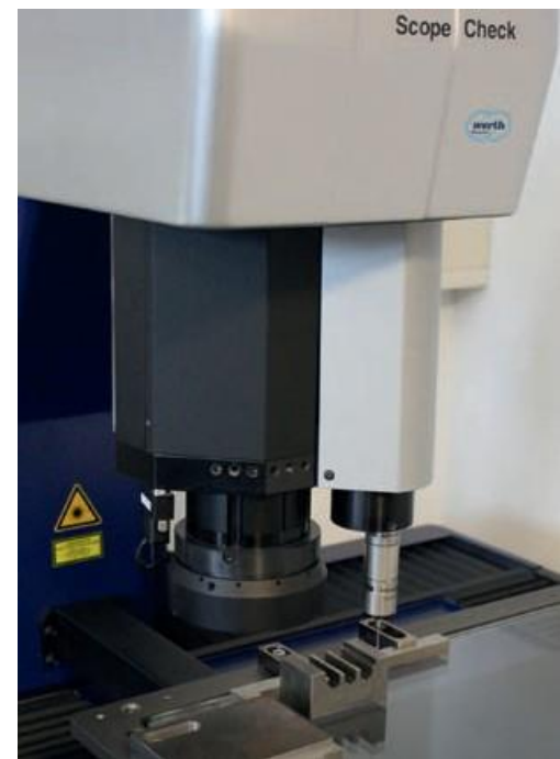
Beim taktilen Messen müssen die Bauteile richtig gespannt werden, um das Ausweichen durch die Berührung zu vermeiden. Die Vorrichtungen werden später in der Serienfertigung übernommen.
