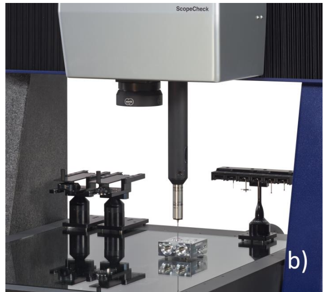
ScopeCheck® FB DZ mit zwei unabhängigen Sensorachsen für kollisionsfreies Messen in der Fertigungsumgebung: a) Bildverarbeitungssensor im Einsatz, b) Taster im Einsatz; im Hintergrund die Parkstationen für Multisensorik und Taststifte
