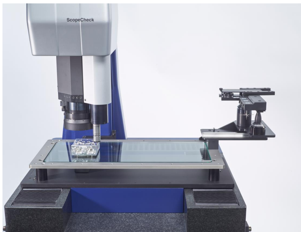
Multisensor-Wechselstation jetzt außerhalb des Messbereichs
