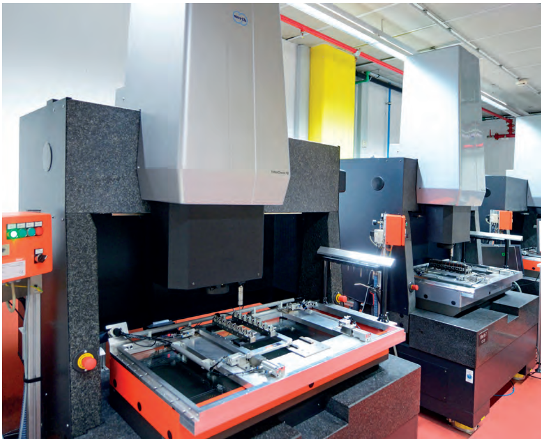
Bild 2: Für hochgenaue Messaufgaben: VideoCheck® Geräte erreichen in ihrer höchsten Genauigkeitsklasse Längenmessabweichungen im Zehntel-Mikrometerbereich
