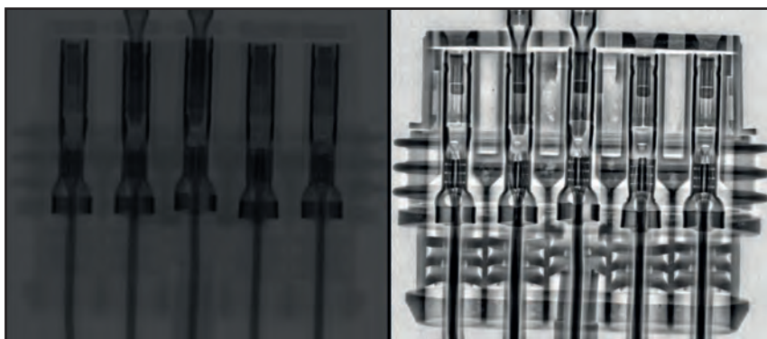
Durchstrahlungsbild mit geringem Kontrast (links) und nach lokaler Kontrasterhöhung (rechts)
