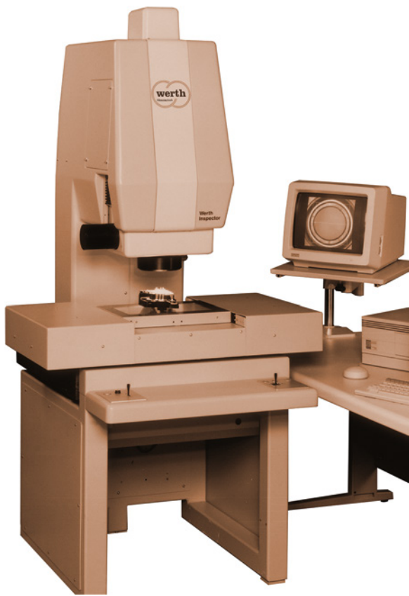
Bild 2: Der Bildverarbeitungssensor – hier der patentierte Werth Zoom mit variablem Arbeitsabstand und Beleuchtungswinkel – ist einer der schnellsten und genauesten Sensoren
