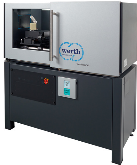
Bild 10: Moderne Geräte mit Röntgentomografie-Sensor vereinen die Vorteile von Transmissions-targetröhren mit einer kompakten Bauweise und geringen Wartungskosten
