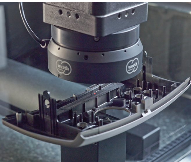
Bild 4: Der patentierte Werth Laser Probe ist in den Strahlengang des Werth Zooms integriert
