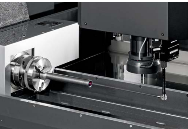
Messung von Innenkontur und Teilungsabweichungen mit konventioneller Drehachse und integrierter Werth-Taumelkorrektur
