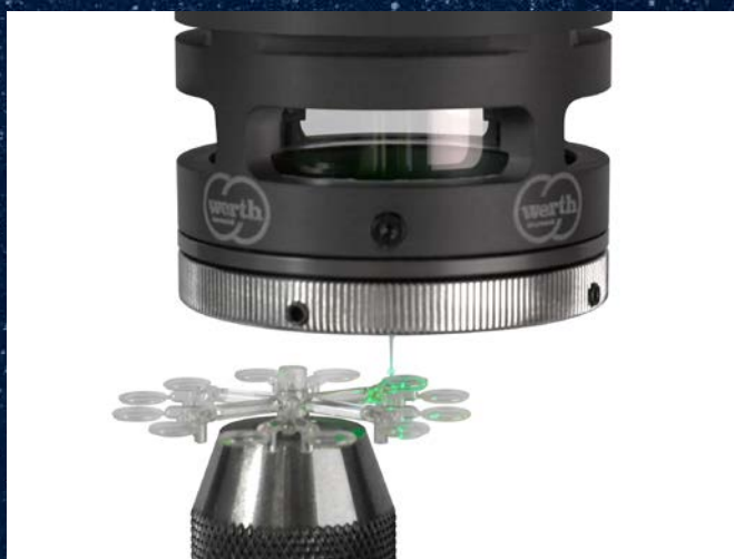
Messung empfindlicher Smartphone-Linsen mit Verth Fiber Probe® 3D
