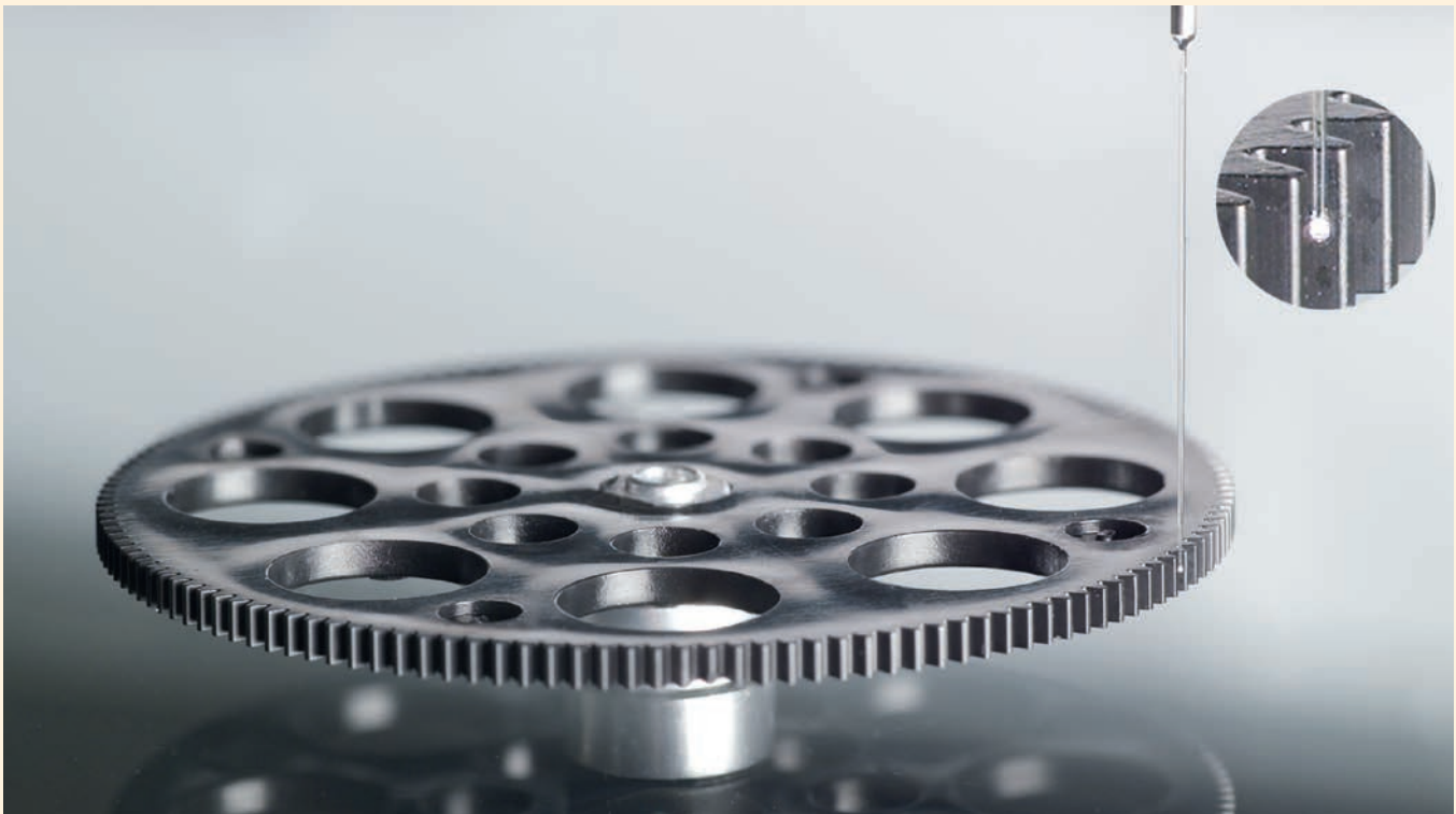
Bild 2. Für präzise Kontrollmessungen in der Fertigung muss ein KMG mit integrierter Temperaturkorrektur eingesetzt werden.
