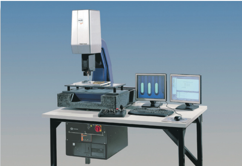
Das Multisensor-Koordinatenmessgerät ScopeCheck mit einem Aufbau auf Hartsteinbasis ist für die Qualitätskontrolle im Werkstattbereich vorgesehen.
