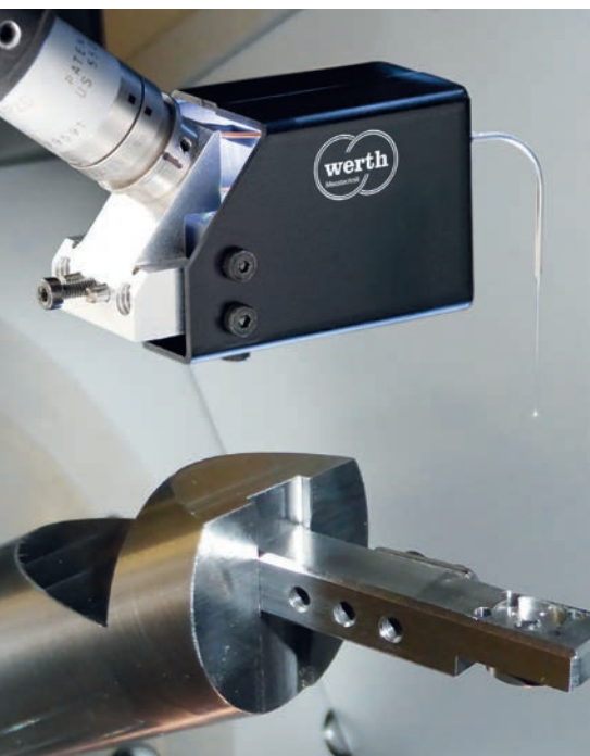
Bild 3. Benzineinspritzdüse: Anordnung an einer Dreh-Schwenk-Achse auf dem Multisensor-Koordinatenmessgerät
