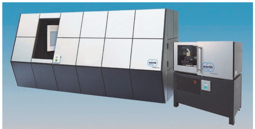
Bild 2. Moderne Geräte mit Röntgentomografie-Sensor ermöglichen fertigungsbegleitende Messungen von Werkstücken unterschiedlicher Größen und Toleranzklassen – links CT-Gerät für die Messung großer Werkstücke mit Röntgenspannungen bis 450 kV, rechts kompaktes, wartungsarmes Messgerät mit 160 kV Röntgenspannung für kleinere Kunststoff- und Metallteile (© Werth Messtechnik)
