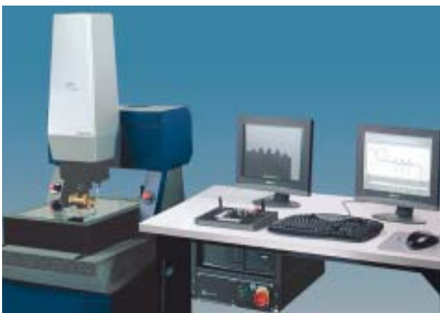
Bild 3: ScopeCheck 400/400/150 oder 400/400/300 – fertigungsnahes Messen mit Messbereichen ab 400 Millimetern in X- und Y-Achse
