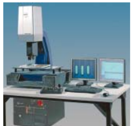
Bild 2: ScopeCheck 300/200/200 oder 400/200/200 – fertigungsnahes Messen auf einem neuen Leistungsniveau in kleineren Messbereichen
