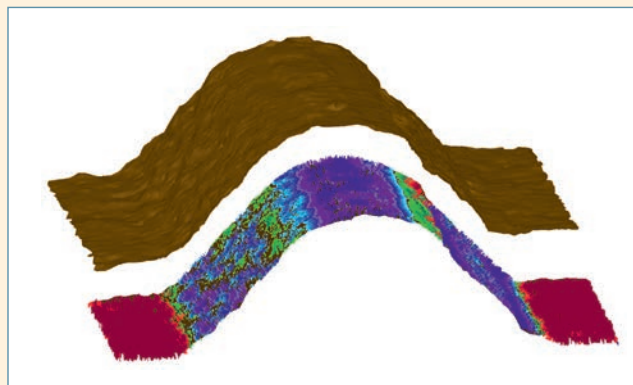
Bild 1. Hochauflösende flächige Messung mit 3D-Patch: vernetzte Darstellung der gemessenen Oberfläche (oben), farbcodierte Abweichungsdarstellung zum CAD-Modell (unten)
