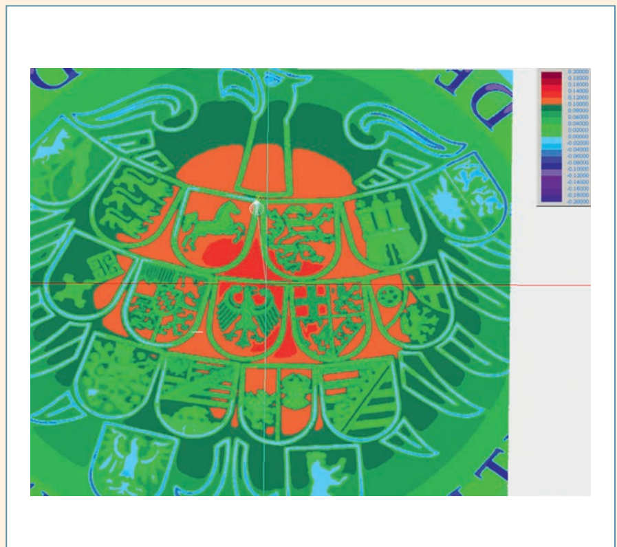
Bild 1. Ungeregeltes Vorgabescanning eines Prägewerkzeugs für Münzen mit einem optischen Abstandssensor (farbkodierte Abweichungen zu einer Ausgleichsebene, da das Modell verständlicherweise nicht vorlag)
