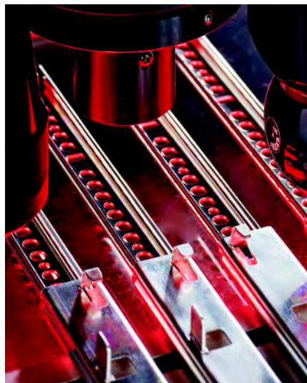
Bild 3: Optische Messung von Bauteilen für Auszugssysteme
